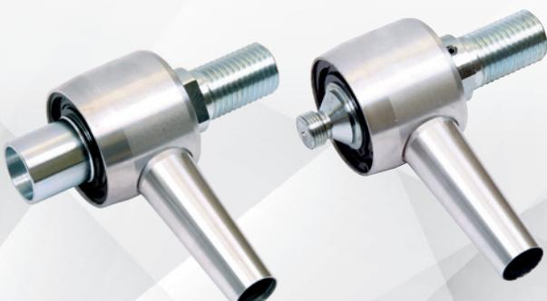
Der CEBOR Absaugrotor ermöglicht die Ausführung von Trockenbohrungen mit Bohrmotoren die nicht für das Trockenbohren mit Staubabsaugung vorbereitet sind. Dazu wird der Rotor zwischen Bohrspindel und Bohrkronen platziert.
