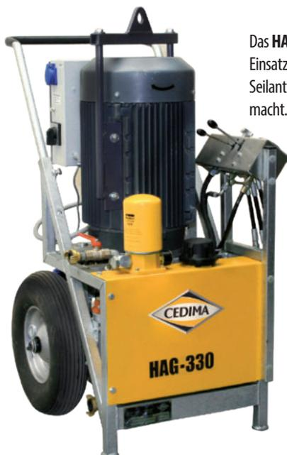
Das **HAG-330** ist aufgrund des hohen Volumenstromes und des maximalen Arbeitsdruckes von 250 bar besonders für den Einsatz großvolumiger Hydraulikmotoren geeignet. Es entsteht hierbei ein hohes Drehmoment am Sägeblatt bzw. am Seilantriebsrad, das sich wiederum in einer höheren Leistung bzw. einer schnelleren Schneidgeschwindigkeit bemerkbar macht. Dieses Aggregat zeichnet sich außerdem durch seine enorme Leistung bei hohem Wirkungsgrad aus.
