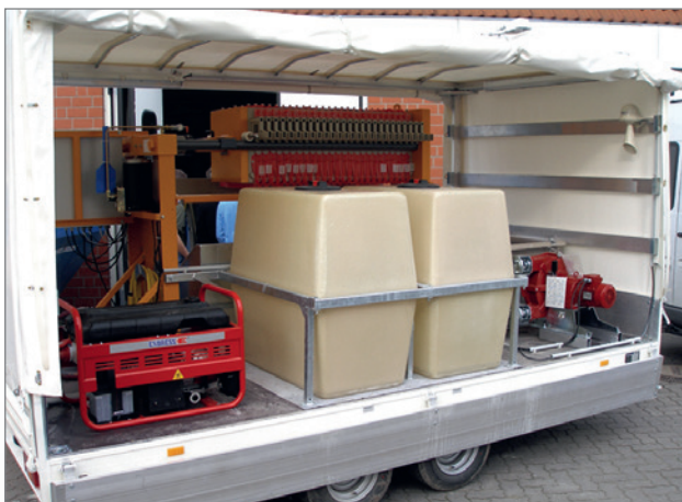
Von links: Stromerzeuger, Klarwassertanks, Schlammpumpe
