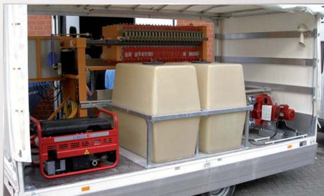
von links: Stromerzeuger, Klarwassertanks, Schlammpumpe
