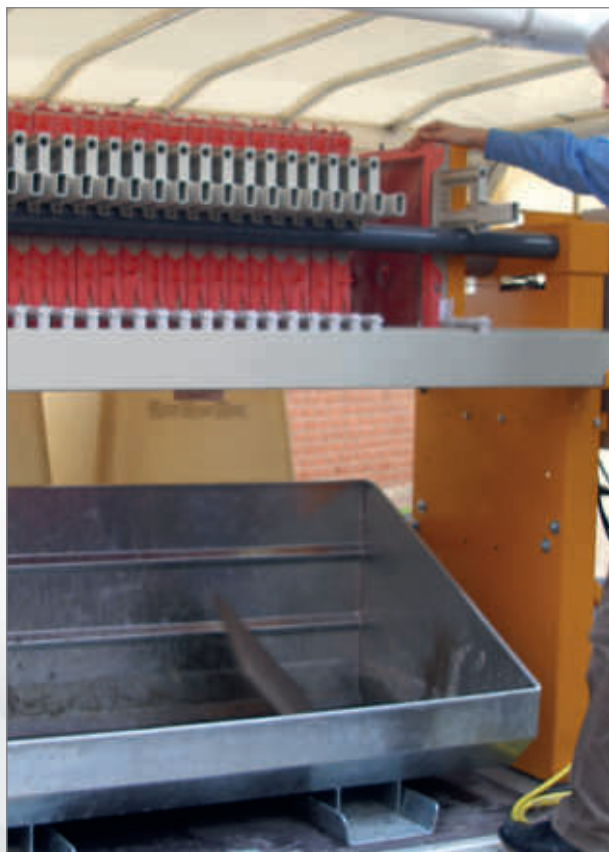
Zum Entleeren des Filters werden die Filterelemente auseinander gezogen.
