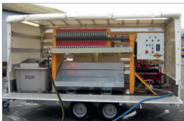
Links: Pufferwanne mit Sieb; Mitte oben: Filterelement; Mitte unten: Reststoffmulde
