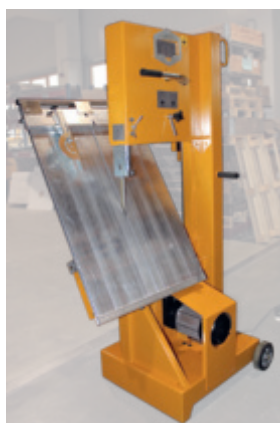
Schneidetisch in Transportstellung
